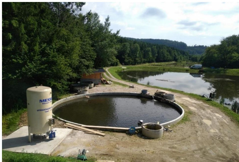
Slika 4: Ribogojnica Žabnik; super intenzivni sistem komunicira z ribnikom, ki ima funkcijo filtra. Avtor: Danijel Gospić, 2019.
