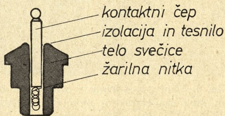
Slika 4. Žarilna svečica. En pol akumulatorja priključimo na ohišje motorja, drugega pa na kontaktni čep
