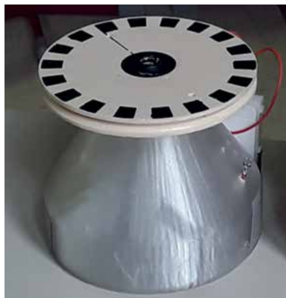
Slika 3: Razvojne faze ohišja z motorjem in vztrajnikom.
