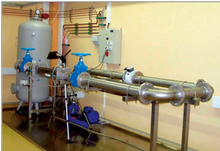
Slika 7. Merilna postaja za raziskovanje hidrodinamične kavitacije
