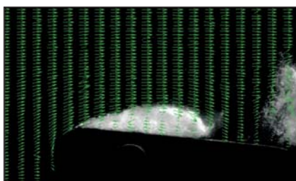
Slika 6. Vizualizacija kavitacije in merjenje hitrostnega polja s PIV-metodo
