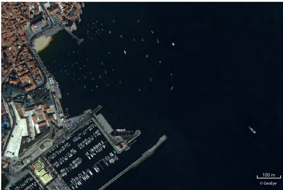
Slika 5. Del mesta Cascais (Portugalska), zajet oktobra 2011 z optičnim senzorjem Geoeye-1, prostorske ločljivosti 1.65 m, prikazan v kompozitu RGB. S slike je razvidno, da je plovila relativno lahko zaznati s posnetka takrat, kadar na njem ni oblakov ali valov, kar nakazuje, da jih je mogoče zaznati s samodejnimi pristopi.
