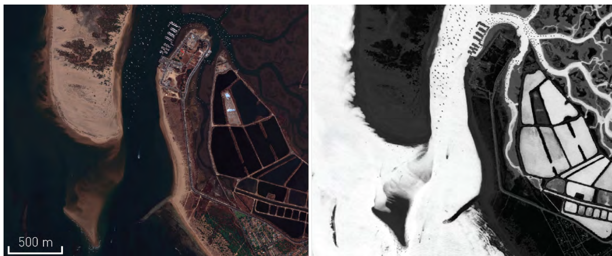
Slika 18. Izvirni posnetek (levo) in NDWI (desno) na posnetku senzorja GeoEye južno od mesta Cadiz (Španija). Vodne površine so v beli barvi izrazito vidne pri izračunu indeksa NDWI, saj so njihove vrednosti višje od ostalih tipov pokrovnosti.
