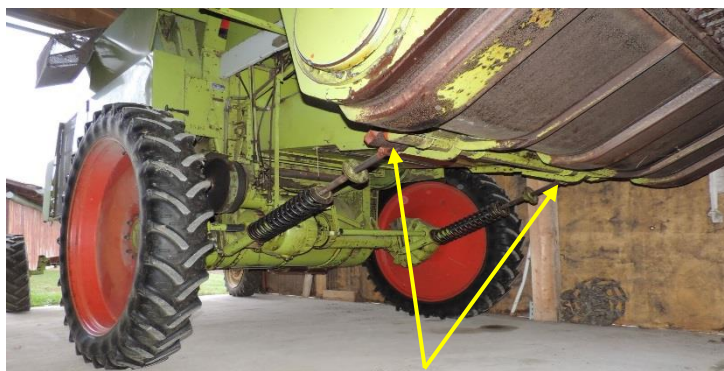
Slika 4: Kolesa večjega premera in spremenjena prijemališča hidravličnih cilindrov
