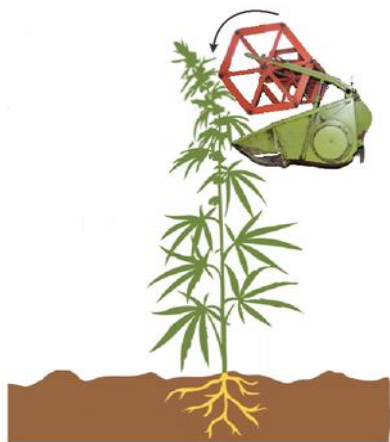
Slika 9: Kosilni greben in motovilo je prenizko in odriwa rastlino.
