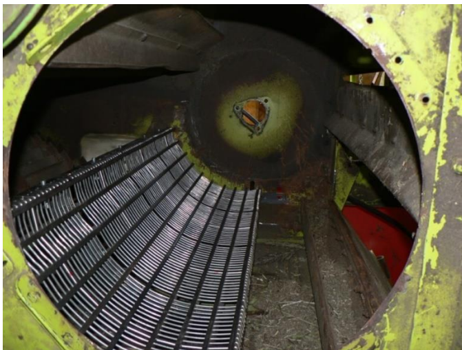
Slika 7: Končna montaža sita v mlatilnico kombajna.
