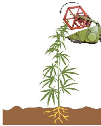
Slika 10: Kosilni greben in motovilo na primerni višini.
