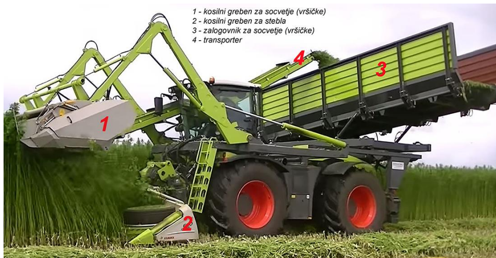
Slika 2: Namensko izdelan kombajn za žetev industrijske konoplje Hemp-flax (Hemp-flax 2017)
