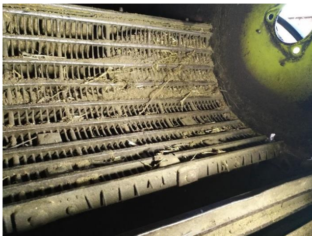
Slika 1: Delno zamašeno sito pod bobnom mlatilnice
