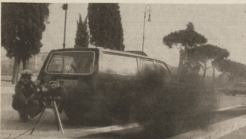
Redar preverja izpušne pline pretirano kadečega se dizelskega avtomobila
