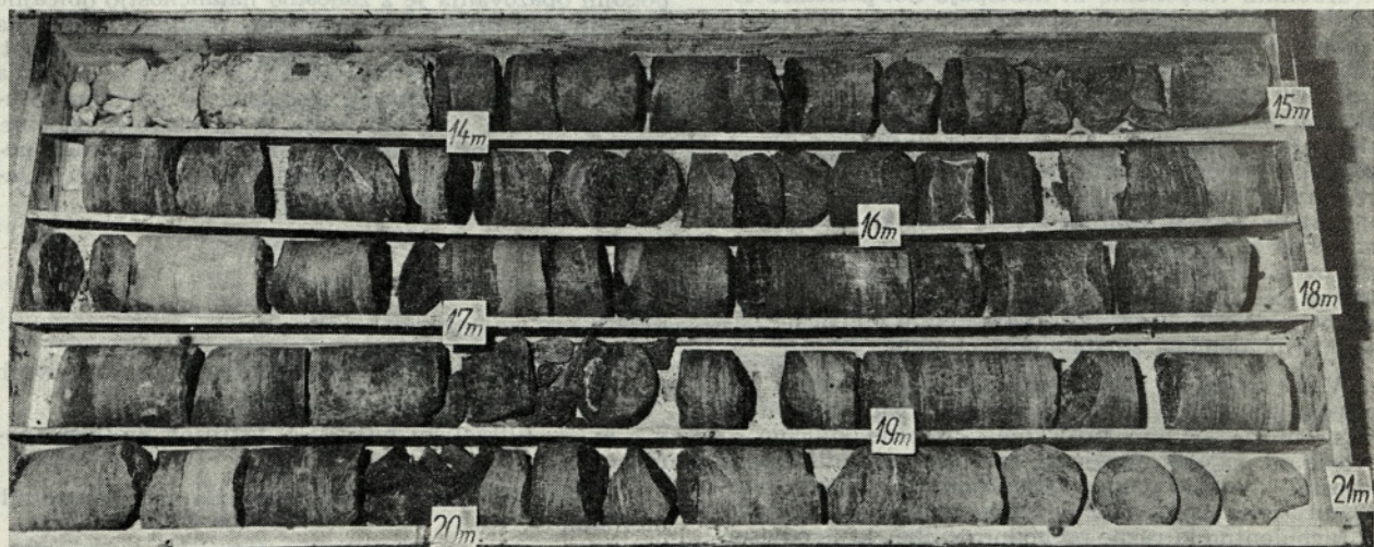
Sl. 7. Vzorci betona in lapornatega glinovca iz vrtime B-4 na HE Mariborski otok
