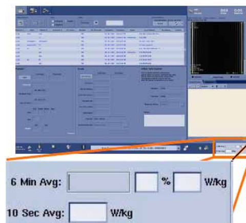
Slika 1: Nadzor oddane radiofrekvenčne energije (GE Healthcare, 2009); oprema glede na vneseno težo in izbrano pulzno zaporedje izračuna obremenitve pacienta s prejeto energijo v W/kg, ki jo tkivu odda RF pulz; izpišeta se povprečni prejete energije v časih 6 minut in 10 sekund.
