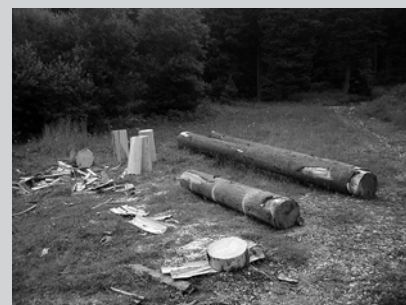
□ Slika 1. Priprava debel iz poključke smreke za izdelavo skodel
