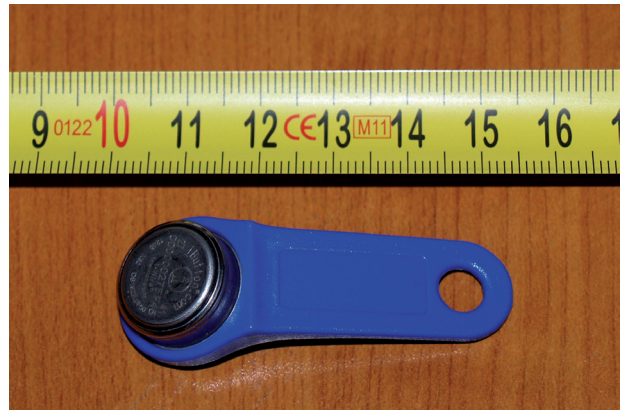
Slika 2. Registrator temperature iButton DS1922L (Foto: G. Vertačnik)
