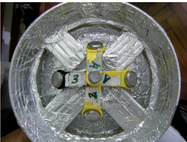
Slika 7. Razporeditev gumbkov v AP zaklonu pri preskusu vpliva usmerjenosti gumbka (Foto: I. Sinjur)
