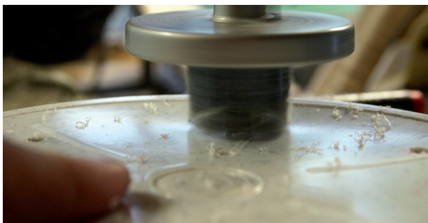
Slika 3. Vrtanje lukenj za zračenje zaklona (Foto: L. Likar)
