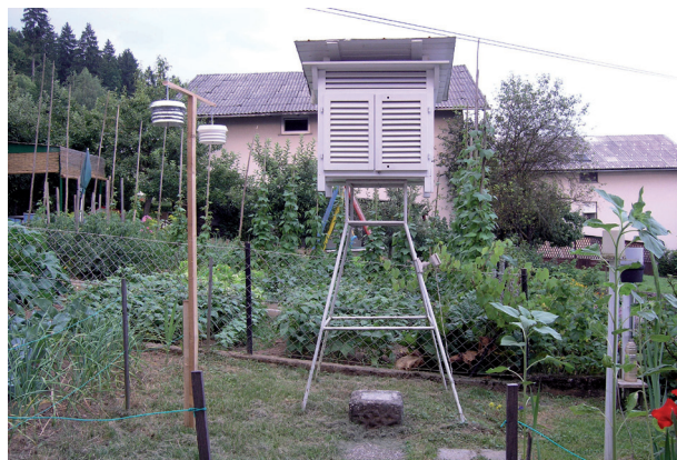
Slika 5. Merilni prostor v Grosuplju, levo AP in BP zaklon, v sredini hišica (Foto: I. Sinjur)
