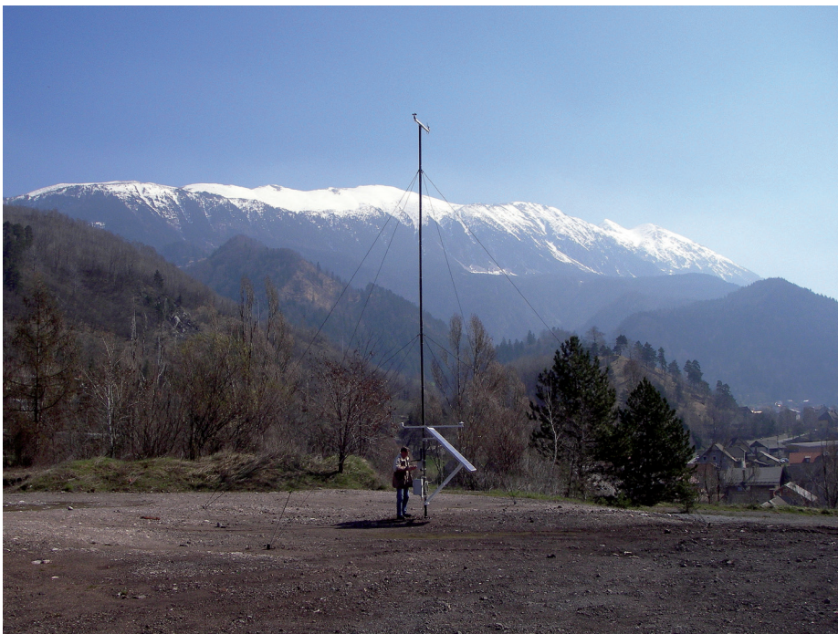
Slika 1. Samodejna meteorološka merilna postaja na eni od lokacij v okolici tovarne Acroni na Jesenicah. Postaja je zbirala podatke za modeliranje širjenja onesnaževal iz izpustov tovarne v ozračje v podrobni krajevni in časovni ločljivosti. Foto: Boštjan Grašič
