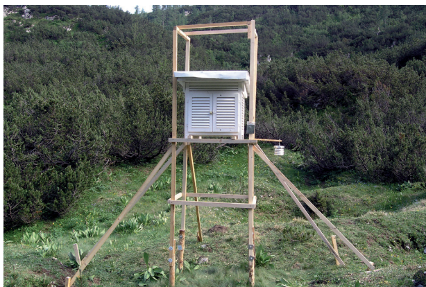
Slika 3. Angleška hišica v mrazišču Luknja na planoti Komna. Desno zadaj je viden AP zaklon za primerjalne meritve (Foto: I. Sinjur)
