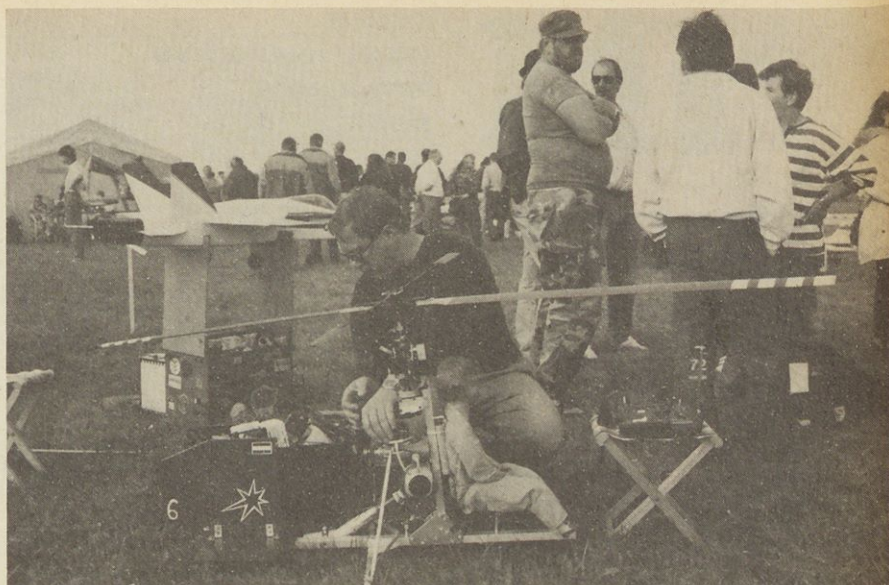
Model žirokopterja, ki za pogon uporablja 15 ccm eksplozijski motorček. V ozadju vidimo polmaketo oziroma »Ducted fan trainer« ameriškega lovca F-18 Hornet.
