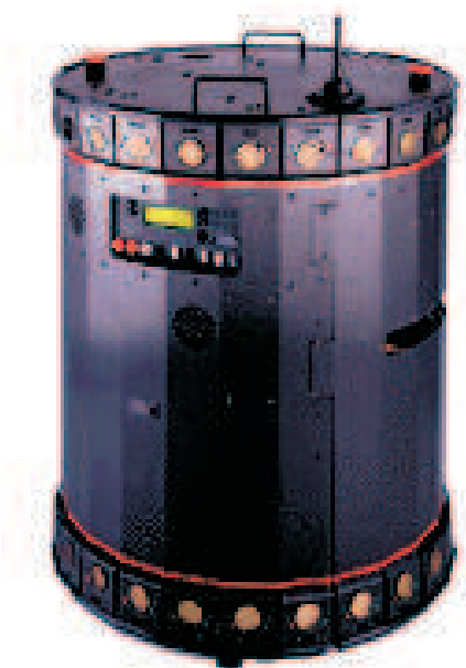
Slika 2.1: Mobilna ploščad Nomad XR4000
