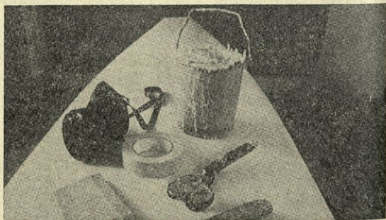
Slika 1. Orodje: Gumijasto strgalo, oster nož, škarje, lepilni trak, če le mogoče naj bo krep trak, maska in posoda za mešanje mase. Na sliki ni ro-kavic, čopiča in smirkovega papirja
