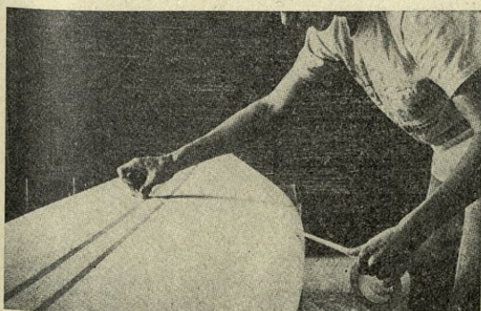
Slika 4. Čiščenje: Pena mora biti pred plastificiranjem povsem brez prahu. Zato jo najprej očistimo s čopičem, nato pa še prevlečemo prek nje lepilni trak, na katerega se prime ves odvečni prah
