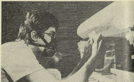
Slika 11. Zadnje dejanje: Plastificiranje končamo z robovi. S strgalko namočimo in pritisnemo k deski stekleno volno na vseh robovih. Namočena steklena volna se mora povsem povsem prilegati jedru. Višek smole odteče pri lepilnem traku na tla; morda jih zato prej prekrijemo s plastično prevleko ali papirjem
