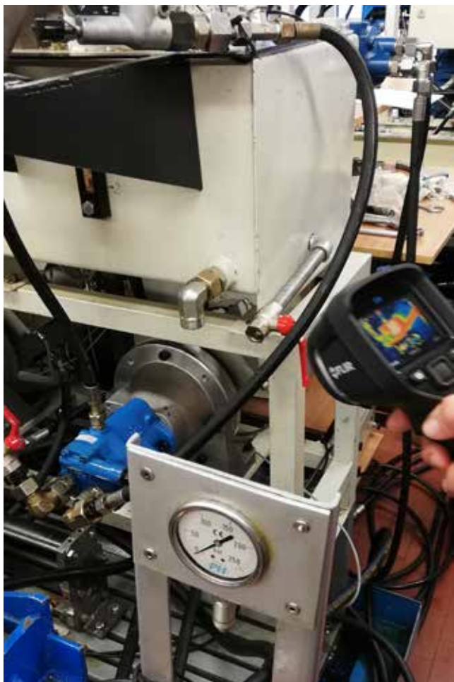
Slika 5 : Uporaba infrardeče termo kamere pri lociranju glavnih virov segrevanja znotraj hidravličnega sistema.
