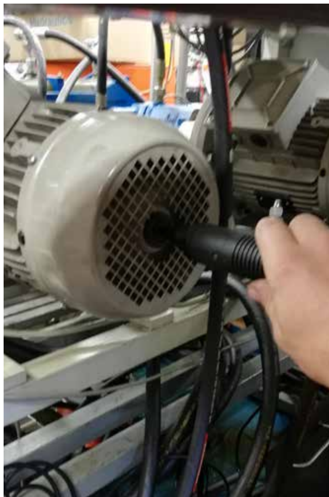
Slika 4 : Uporaba tahometra pri meritvi dejanske vrtilne hitrosti pogonskega elektromotorja.
