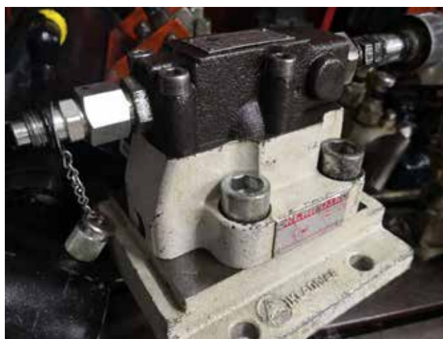
Slika 1: Dvostopenjski varnostni ventil.
