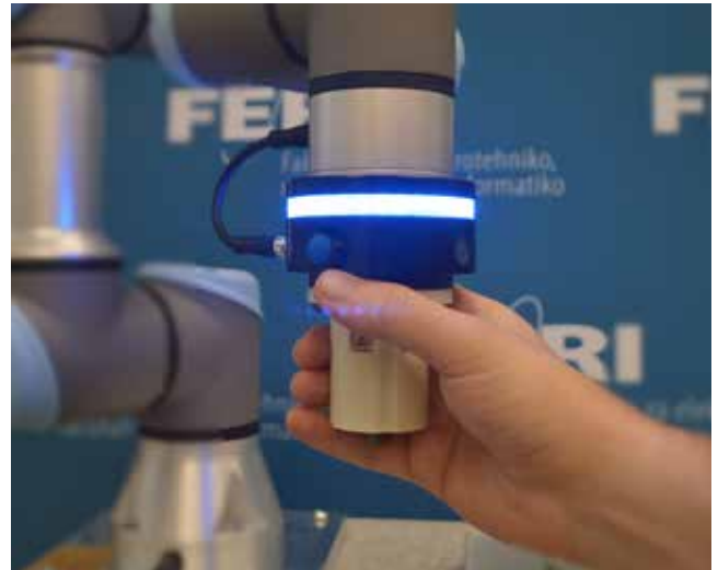
Slika 3 : Fizična interakcija človek - robot.
