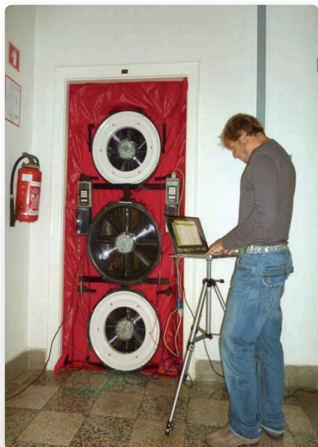
Oprema za test zrakotesnosti (Blower door)
