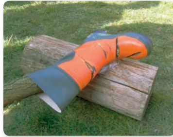
Tudi zaščitni čevlji je možno prerezati z motorno žago
