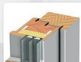
Prerez zunanjih vrat, pasivna izvedba, www.doors.si
