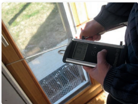
Odkrivanje netesnih mest z ročnim anemometrom
