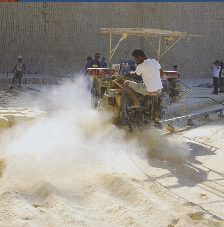
Način rezanja kamnitih blokov, rezilka potuje po tirnicah, kvadre sproti odmikajo na stran. Delo rezanja poteka dokaj hitro.
