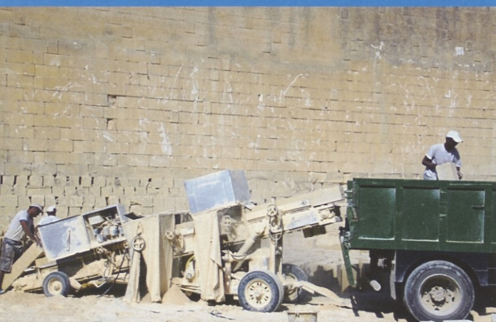
Nakladanje na kamion po tekočem traku in z uporabo skolbeljnika. Nastali prah uporablja pri vezni malti za zidanje, tako dobi zid iz kamna monolitni videz. Skromnost, varčnost, preudarnost
