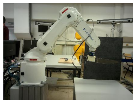
Slika 8. Robot Motoman MH5 s pritrdjenim nožem.
