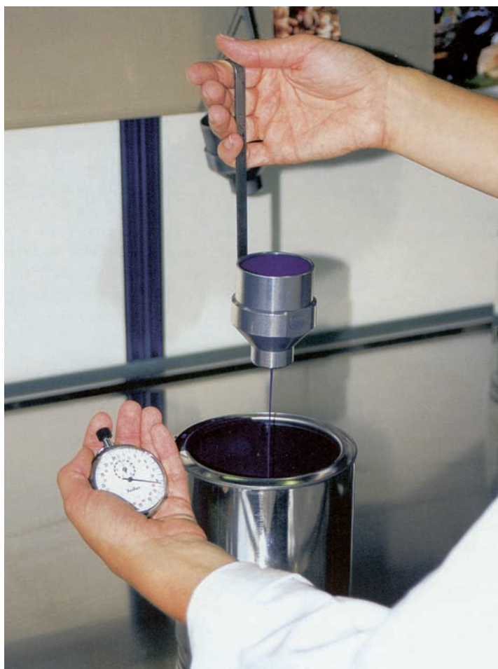
Slika 38. Merjenje viskoznosti fleksotiskarske barve.
