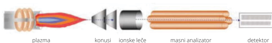
Slika 44: Shematski prikaz ICP-MS sistema
