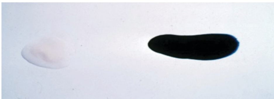
Slika 48: Kvalitativno določanje nitratov in nitritov (levo: negativna reakcija, desno: pozitivna reakcija)
