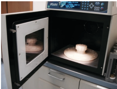
Slika 42: Priprava vzorca za določanje elementov (levo: mikrovalovna pečica, desno: teflonski lončki za razklop vzorcev)
