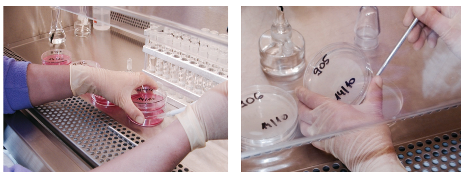
Slika 33: Nanašanje vzorca na gojišče (levo: plesni in kvasovke (1 mL iz razredčitve vzorca 10^{-3} ); desno: bakterije (0,1 mL iz razredčitve vzorca 10^{-4} ))
