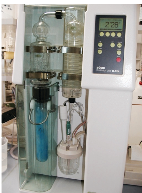
Slika 14: Dodajanje baze in destilacija amonijaka
