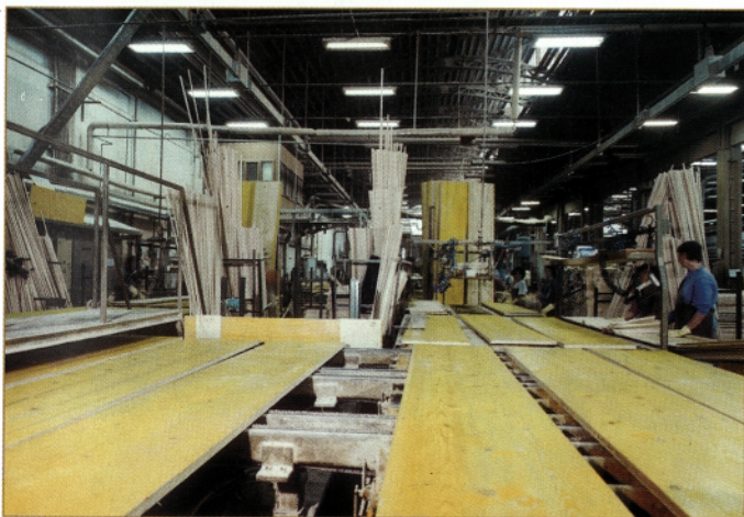
Proizvodnja opažnih plošč.
