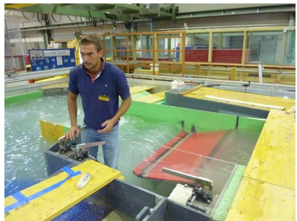
Slika 9: Hidravlični laboratorij Tehnične univerze v Innsbrucku, model deskarskega (surferskega) bazena z umetnim valom
