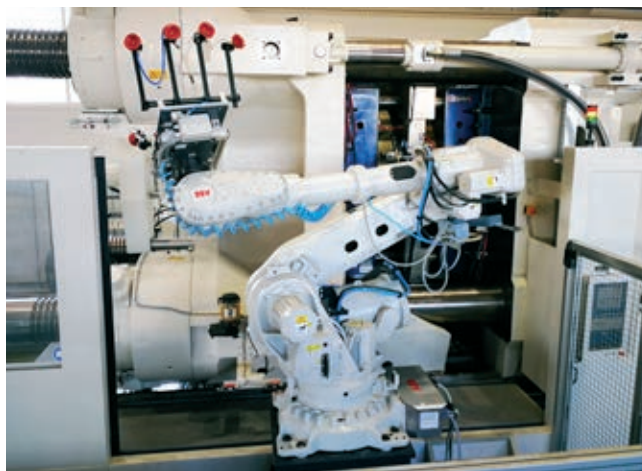
» Za odvzem izdelkov iz orodja skrbi robot ABB – teža trenutno največjega izdelka je približno 45 kg.
