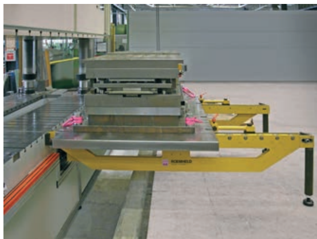
» Slika 2: Konzole za zamenjavo orodij s podpornimi nogami in pogonom (Slika: ROEMHELD).
