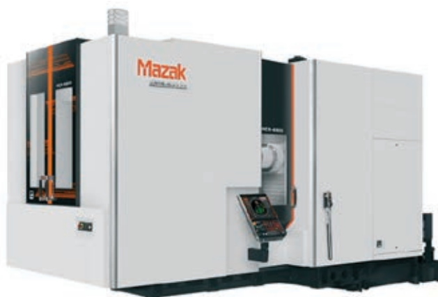
» Horizontalni obdelovalni center HCN-6800 ima vreteno CAT 50 z 10.000 obrati na minuto in 50 konjskih moči odrezovanja raznolikih materialov od jekla do neželeznih kovin. Stroj ima delovno območje 1.050 x 900 x 980 mm (X-Y-Z) ter hitrost hitrega podajanja 60 mm/min v posamezni osi ter pospešek 0,8 G, medtem ko se standardna vpenjalna miza na centru HCN-6800 zavrti za 90 stopinj v 1,9 sekunde. Na razpolago sta opcijsko NC-pozicioniranje in NC-rotacijska miza, kar še bolj poveča natančnost pozicioniranja na 0,001 stopinje pri prvi opciji in 0,0001 stopinje pri drugi. Vir: Mazak
