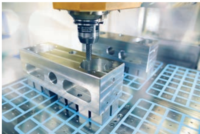
» Visokozmogljiva hidravlično ekspanzijska držala za orodja, kot je TENDO E compact proizvajalca Schunk, omogočajo velike sile vpenjanja in varen prenos navora do 900 Nm, odvisno od premera vpetja. Vir: SCHUNK
