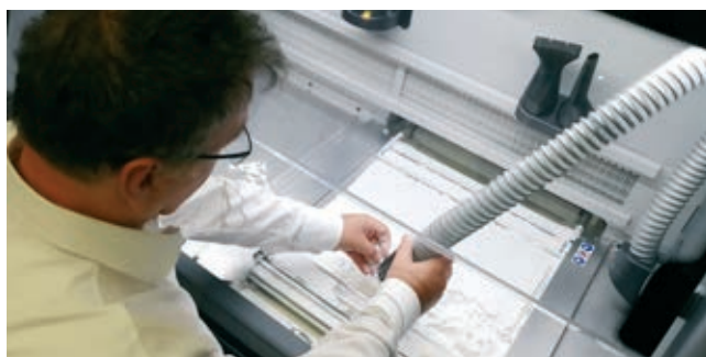
» Procesna enota in čiščenje po 3D-tiskanju
