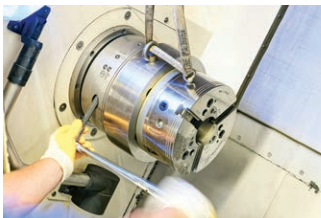
» Za povezavo manjše vpenjalne glave ROTA THW plus 260 s sistemom hitre menjave ROTA FSW proizvajalca Schunk se uporablja posebej razvit adapter. Vir: SCHUNK
