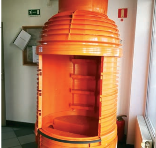
» Kanalizacijski jašek v prerezu, sestavljen iz treh brizganih kosov. V notranjosti lahko opazimo stopnice za intervencije v primeru težav.
