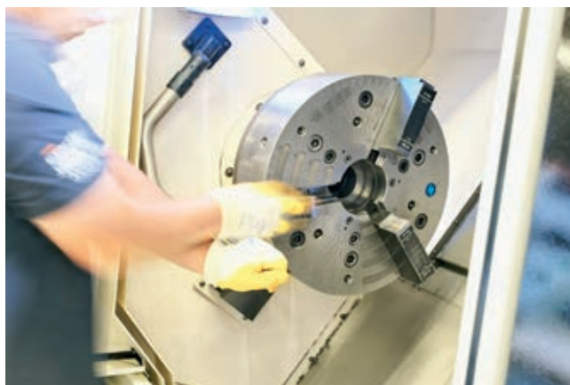
» Vpenjalna glava ROTA THW 500 omogoča izjemno hitro menjavo vpenjalnih čeljusti, ki lahko tehtajo do 8 kg. Vpenjalna glava s sistemom hitre menjave zagotavlja pri obdelavi doseganje opleta manjšega od 0,3 mm. Vir: SCHUNK
