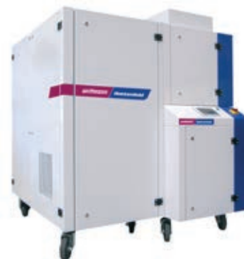
» Kompresor in generator dušika za postopek brizganja s plinom GIT AIRMOULD
