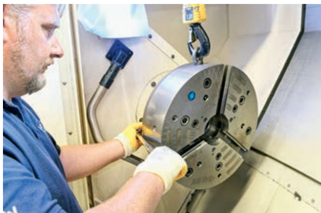
» Za pritrditev glave s sistemom za hitro menjavo ROTA FSW je treba priviti le en vijak. Vpenjalni sistem samodejno centrira ohišje vpenjalne glave. Vir: SCHUNK
