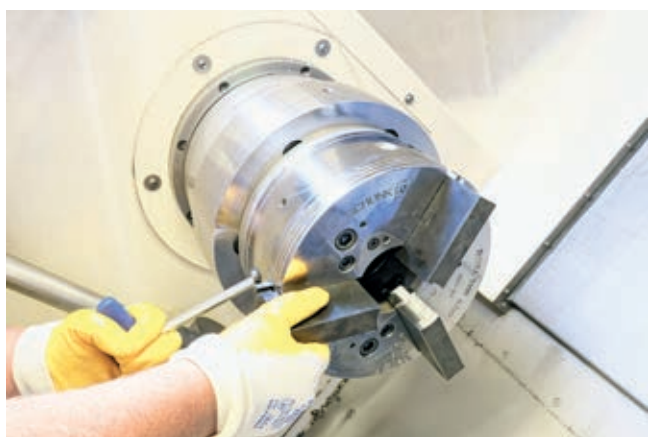
» Že obdelane vpenjalne čeljusti se na vpenjalni glavi ROTA THW plus 260 podjetja Schunk lahko z visoko natančnostjo zamenjajo v nekaj enostavnih korakih. Vir: SCHUNK
