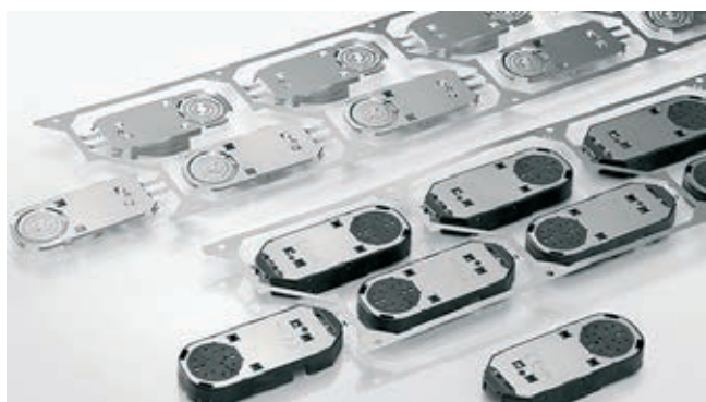
» Proizvodnja ohišij kartuš naprav za merjenje sladkorja v krvi. Vir: GOM
