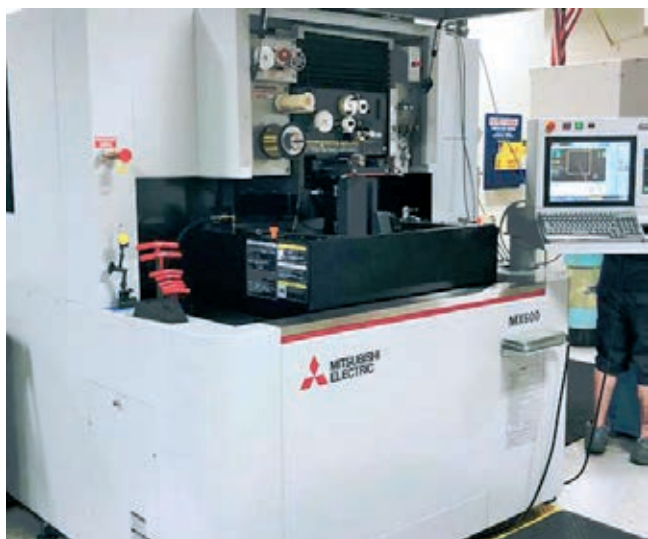
» Stroj za oljno žično elektroerozijo MX600 v proizvodnem obratu za mikro brizganje podjetja MTD Micro Molding. Vir: MTD Micro Molding
