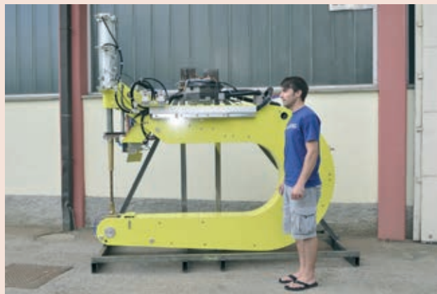
» Primerjava velikosti med osebo in največjimi robotskimi varilnimi kleščami na svetu
