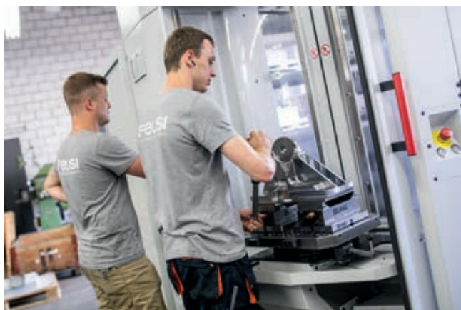
» Operaterju prijazna postaja za nastavitve na paletnem sistemu za obdelovance PW 150. Vir: Feusi AG
