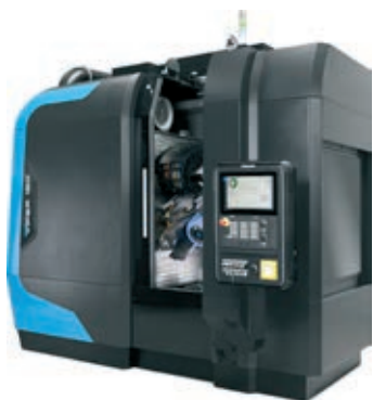
» Stroj Speed Viper 180 proizvajalca Höfler za izdelavo cilindričnih zobnikov s postopkom brušenja. Vir: Klingelberg
