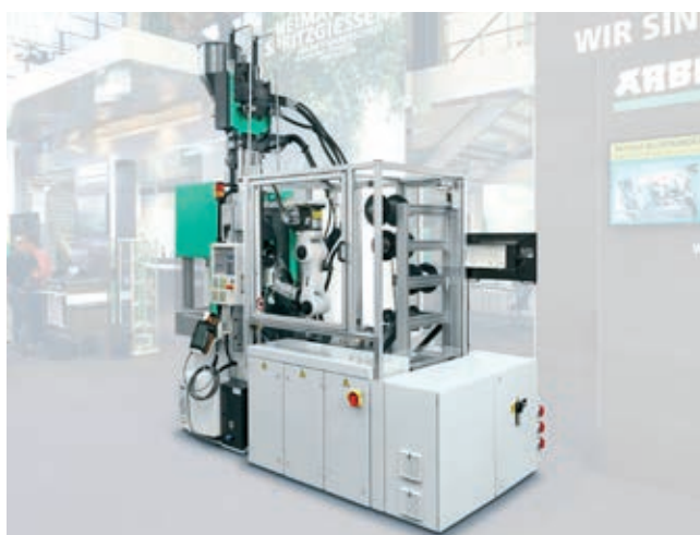
» Fleksibilna proizvodnja velikega obsega »na zahtevo«: sistem na ključ, zgrajen okoli vertikalnega stroja Allrounder 375 V s šestosnim robotom v kompaktni konfiguraciji bo na Industrijskem sejmu 2019 proizvajal več različnih elastičnih napenjalnih trakov v skladu z zahtevami stranke. Foto: ARBURG
