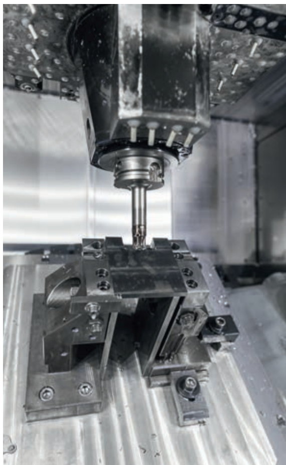
» Obdelovalni prostor 5-osnega visokozmogljivega obdelovalnega centra C 42 U z nihajno rotirajočo vpenjalno mizo dimenzij 800 x 630 mm in vpenjalna naprava pritrjena na paleti namenjeni 5-osni obdelavi obdelovanca. Vir: Hermle
