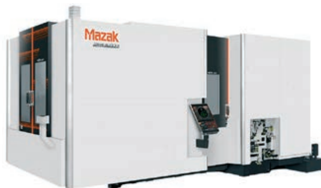
» Horizontalni obdelovalni center HCN-8800 ima vreteno CAT 50 ter delovno območje 1400 x 1200 x 1320 mm (X-Y-Z) ter hitrost hitrega podajanja 60 mm/min v posamezni osi. Vir: Mazak
