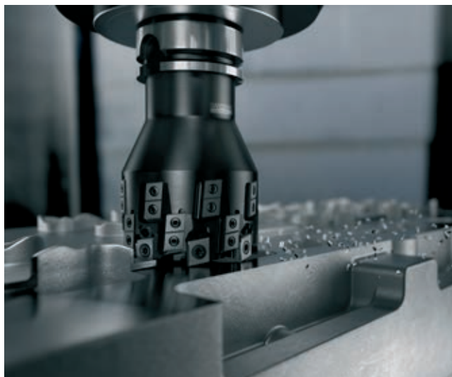
» Novo orodje M5Q90 namenjeno frezanju aluminijastih ulitkov za avtomobilsko industrijo proizvajalca Sandvik Coromat. Vir: Sandvik Coromat
