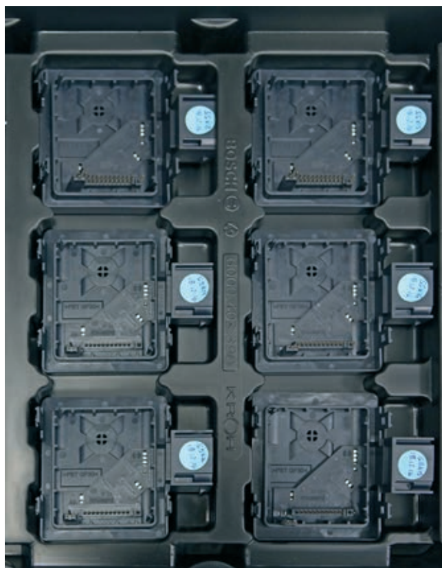
» Prvi vzorci za primerjavo posameznih gnezd večgnezdnega orodja za brizganje plastike. Vir: GOM
