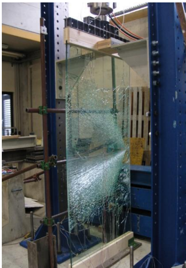
Slika 37: Porušitev tlačno obremenjenega lameliranega steklenega panela. Figure 37: Failure of compressed laminated glass panel.
