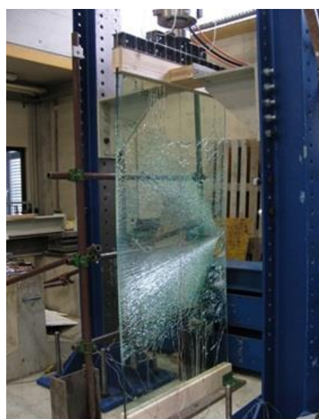
Slika 9: Primerjava obnašanja lameliranega stekla po poružitvi sestavljenega iz kaljenega stekla (levo) [21] in delno kaljenega stekla (desno).
