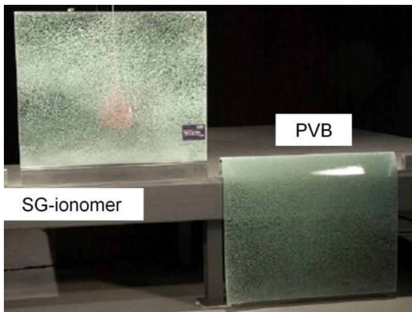
Slika 7: Primerjava obnašanja lameliranega stekla z uporabo SG-ionomer (levo) in PVB vmesne povezovalne plasti (desno) po razpokanju stekla; prevzeto iz [20].
