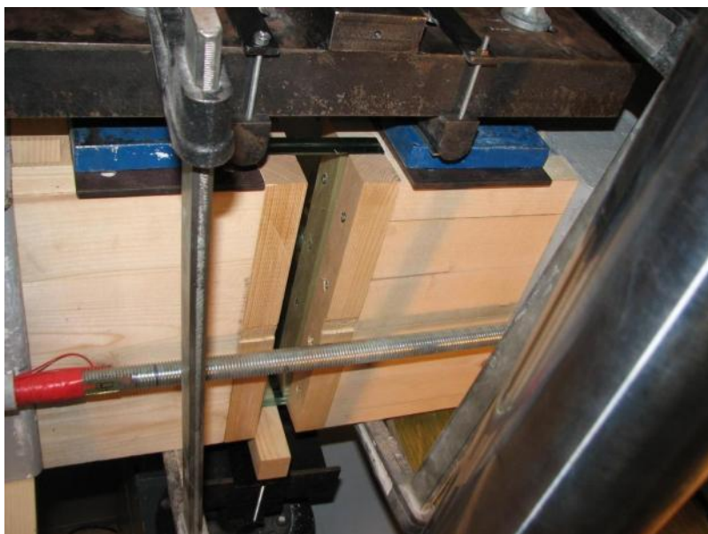
Slika 43: Prikaz vpetja stekla v leseno ležišče. Figure 43: Glass plate in the timber embedment.
