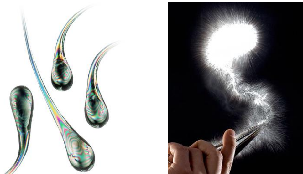
Slika 3: Potek razporeditve zaostalih napetosti na površini strjenih steklenih kapljic (levo) in eksplozivna porušitev (desno); prevzeto iz [16].
