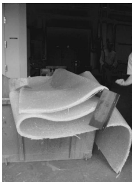
Slika 9: Primerjava obnašanja lameliranega stekla po poružitvi sestavljenega iz kaljenega stekla (levo) [21] in delno kaljenega stekla (desno).
