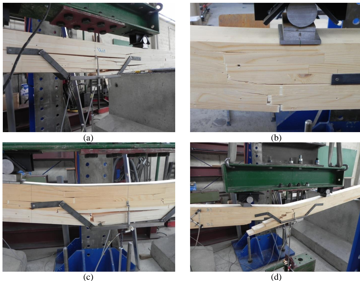
Slika 49: Porušne oblike upogibno obremenjenih lameliranih lesenih nosilcev. Figure 49: Failure modes of bending loaded laminated wood beams.
