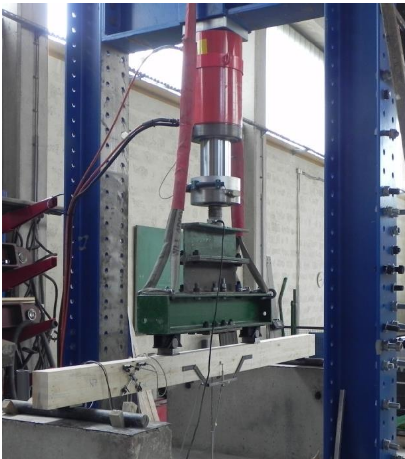
Slika 47: Pogled na postavitve štiri točkovega upogibnega testa nosilca v laboratoriju. Figure 47: Four point bending test setup in laboratory.
