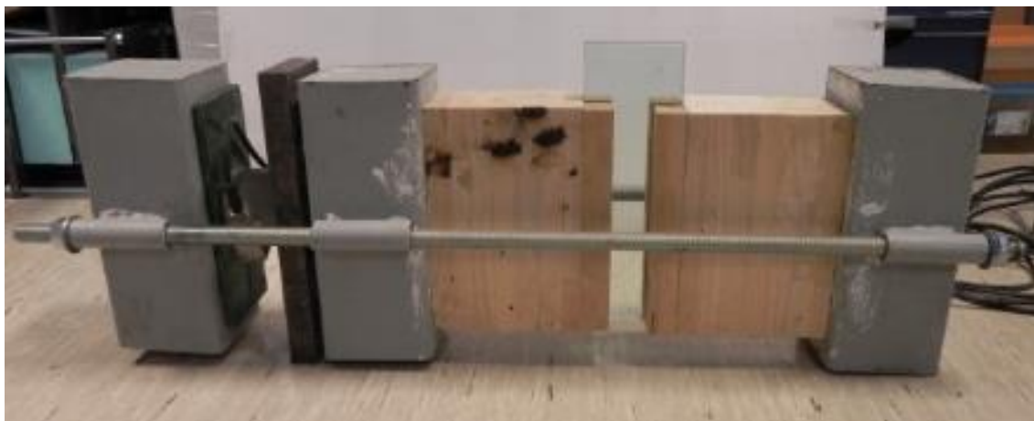
Slika 44: Sistem za vzdrževanje normalne komponente sile F_n . Figure 44: Mechanism for applying the normal force component F_n .
