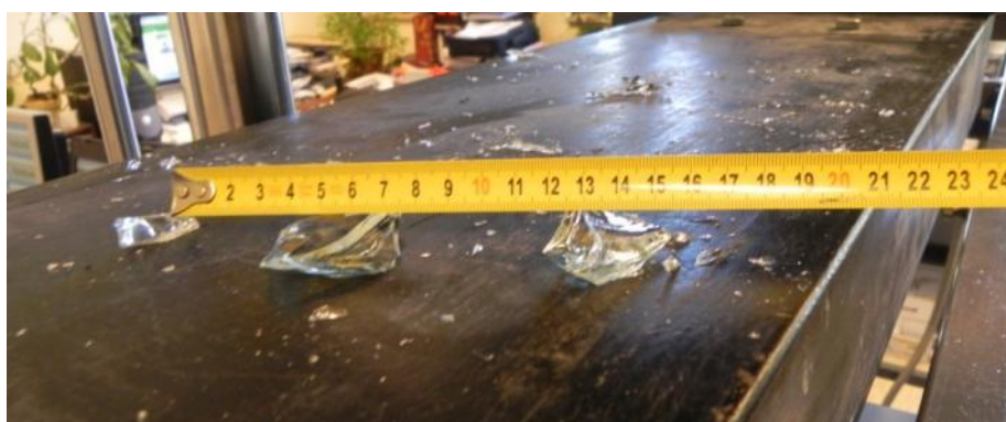
Slika 24: Odpadanje večjih steklenih delcev po poružitvi, prisotno pri preizkušancih s PVB folijo. Figure 24: Glass fragments falling off after the glass failure, typical for specimens with PVB interlayer.
