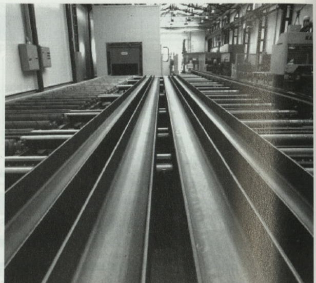
Slika 22: Prečni transporterji kot vmesni zalogovniki na potji obdelave materiala (H profili)
