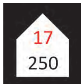
Vzpon 17 ‰ na dolžini 250 m. Proga se vzpne za 4,25 m pod kotom 1°.
