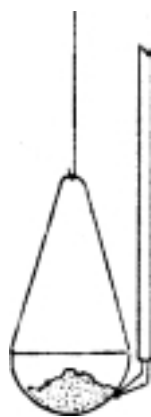
Slika 2: Termočlen, ki zaznava temperaturo vzorca, se z zunanje strani dotika merilnega lončka
