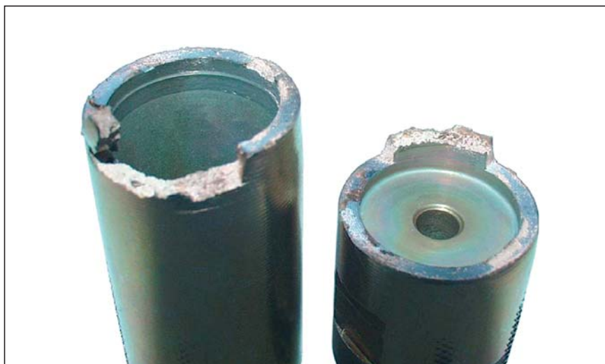
Slika 9. Delno žilav prelom – počasna porušitev epruvete
