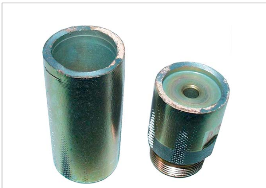
Slika 8. Krhki prelom – hipna porušitev epruvete
