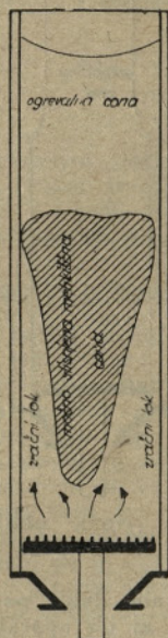
Slika 2. Zastoj v delovanju peči zaradi neprimerne valjaste oblike
