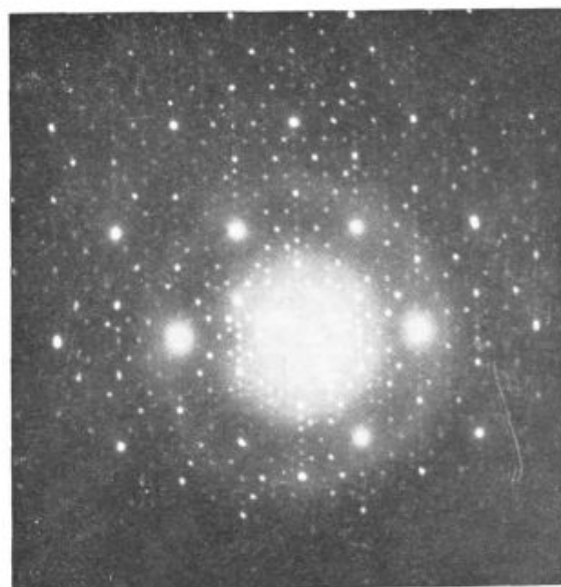
Slika 4 Elektronski uklonski diagram nitridnega zrna na sl. 3.
