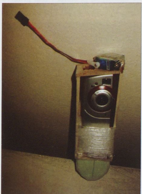
Škatlica s fotoaparatom in servomehanizmom za proženje
