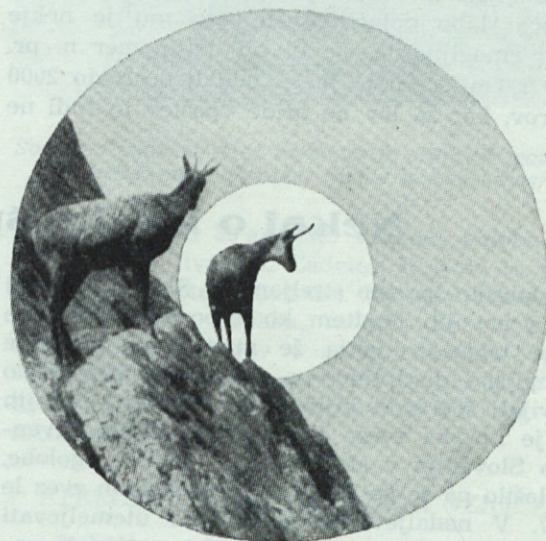
Uravnana vizura desnega objektivna s pomočjo bobniča. Daljino odčitamo pri marki
