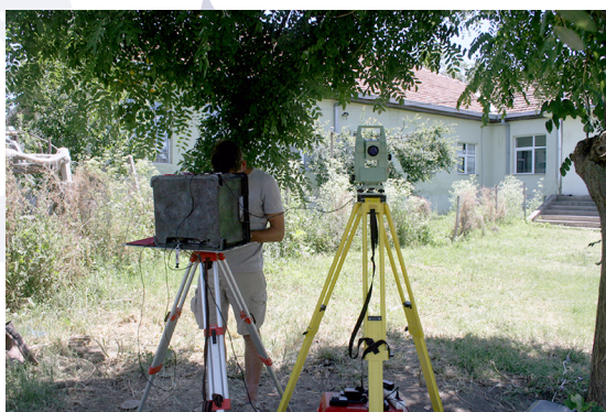
Slika 4. Mogila, delo na terenu (georeferenciranje arheoloških ostalin) – merjenje s totalno postajo (foto: Aleš Ogorelec, arhiv UP FHS IAD).
