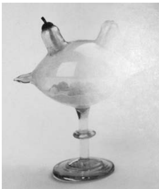
Slika 8: Crookesova vakuumna elektronka s fluorescenčnim zaslonom, poldrugo stoletje star model v Italijanski gimnaziji Koper
