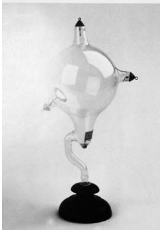
Slika 9: Geisslerjeva in Crookesova vakuumna elektronka, poldrugo stoletje star model v Italijanski gimnaziji Koper
