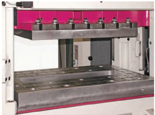
» Magnetna vpenjalna plošča uporabljena na „TOP Line 2000“ preši Andritz Kaiser (Slika: ROEMHELD).
