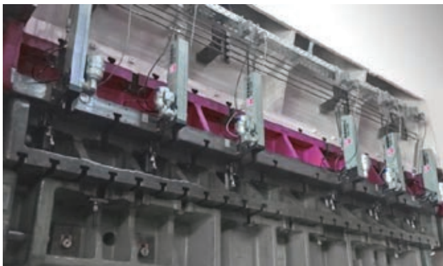
» Hitrovpenjalni sistem Flexline v realnem času meri podatke o vpenjalnih silah paha preše in jih posreduje krmilju stroja (Slika: ROEMHELD).
