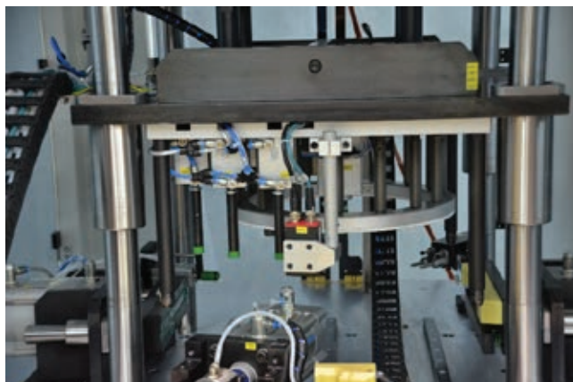
» Slika 2: Vpenjalna priprava naprave za testiranje tesnosti
