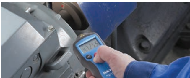
» Slika 2: Uporaba tahometra pri meritvi dejanske vrtilne hitrosti ventilatorja ali vodne črpalke (SKF)
