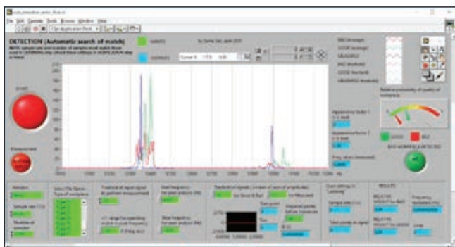
» Slika 4: Zaznavanje morebitnih napak iz signala akustičnega odziva preizkušanca (modra linija).
