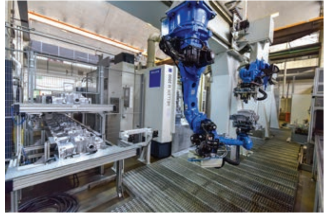
» Avtomatizirana strega obdelovalnih strojev v obratu Ljubljana (Foto: Andrej Tarfila)
