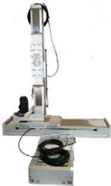
» Slika 2: Postavitev linearnih vodil v obliki kartezičnega koordinatnega sistema
