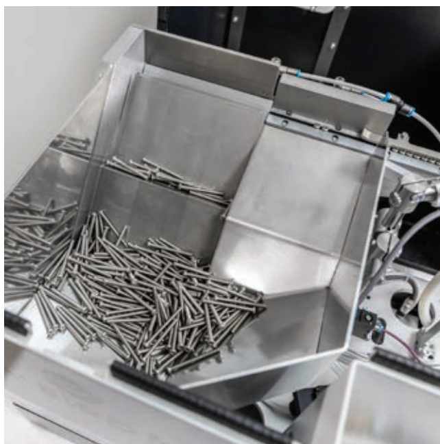
» Delovanje koračnega dodajalnika eacy step feed podjetja Deprag, ki je posebej zasnovan za strego daljših vijakov. | Vir: Deprag
