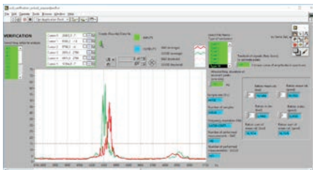
» Slika 3: Vrednosti lastne frekvence za dobre (zeleno) in slabe (rdeče) kose.
