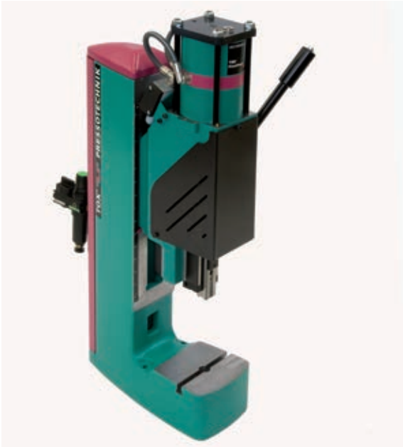
» Pnevmatika stiskalnice TOX® FinePress PFHL s pnevmatsko podporo pri delovnem in vračalnem gibu, standardne izvedbe s povečano delovno širino in silo stiskanja do 22,5 kN.
