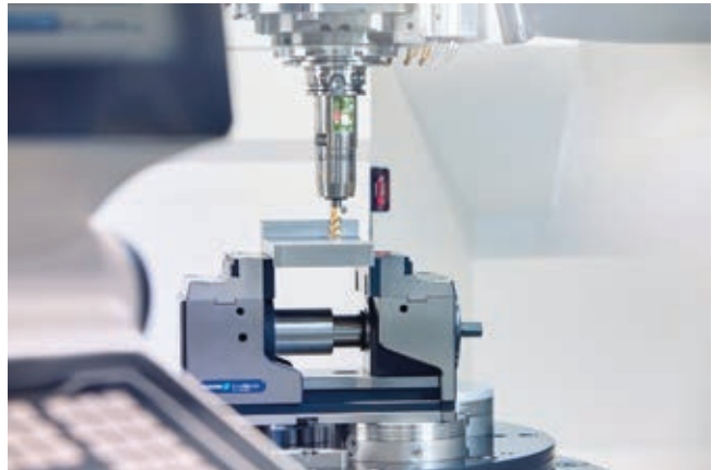
» Držalo orodij prihodnosti – pametni iTENDO omogoča spremljanje in nadziranje procesov v realnem času neposredno na orodju.
