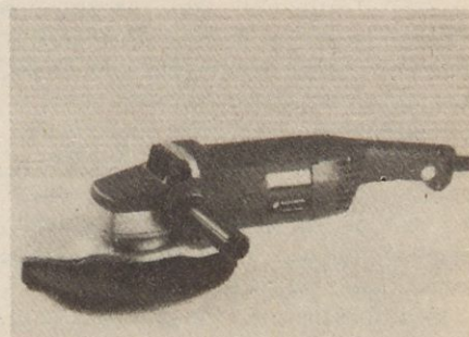
Kotni brusilnik P 54-16 je najmanjši od petih modelov, ki jih izdeluje tovarna Black & Decker Jugoslavija. Je kompakten, priročen in tehta le 1,6 kg. Motor z močjo 600 vatov poganja ploščo s premerom 120 mm s hitrostjo 11 000 vrtljajev v minuti.
