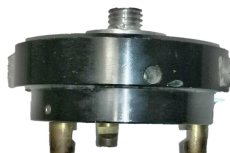
Slika 3.13: Adapter za prisilno centriranje skenerja Riegl VZ-400
