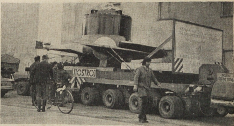
To pa je tovar, to. (Premer 5620 mm, višina 2700 mm, teža pa 72 ton, moč turbine 45.000 kW. Skupna teža opreme za HE Varaždin je 1600 ton.)
